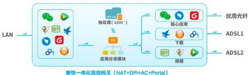
全新一代基于 DPI 的流量识别机制，全面提升 7 层应用协议识别速度和准确性，实现从终端到流量的可视化管理，数据全面直观呈现，更加精细化的流量管控配合多线接入、多拨技术、链路均衡和应用分流等功能结合，加之不间断更新的 3200 款以上 DPI 特征库，将核心应用分流至优质光纤，将下载、视频等应用分流至低价的 ADSL 宽带，降低 80%以上的带宽成本。
