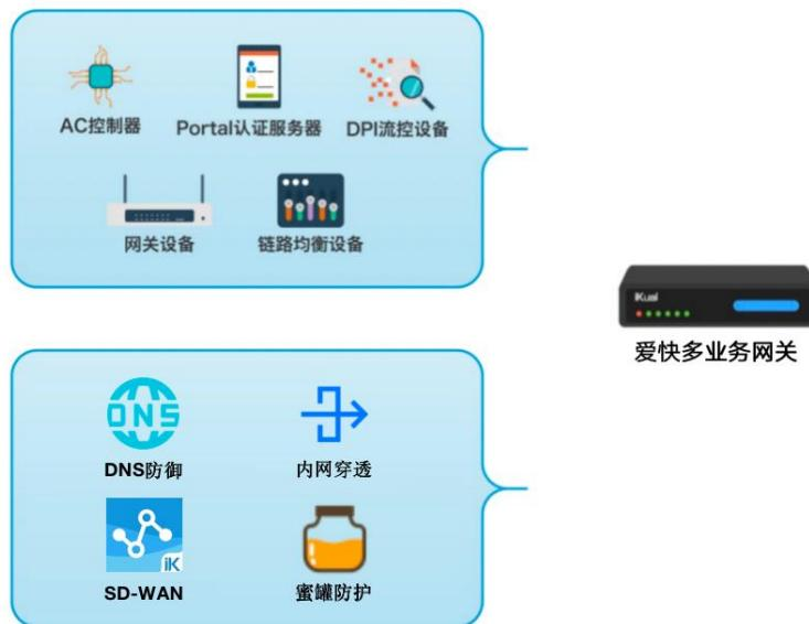
爱快在高性能硬件平台上集成了包括 DPI 流控、负载均衡、网关、AC、认证服务器等功能, 将传统组网模式整合并做简化, 等同于将多台设备以及统一网管平台整合到一台设备, 大幅降低了企业组网和维护成本; 同时, 传统组网中很多设备都采用串联组网方式, 爱快融合网关很大程度上避免了单点性能瓶颈而降低整网性能。
