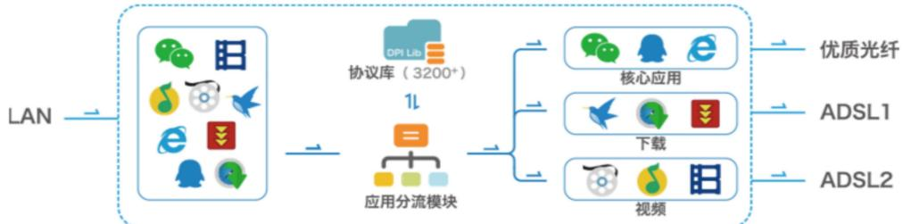
全新一代基于 DPI 的流量识别机制，全面提升 7 层应用协议识别速度和准确性，实现从终端到流量的可视化管理，数据全面直观呈现，更加精细化的流量管控配合多线接入、多拨技术、链路均衡和应用分流等功能结合，加之不间断更新的 3200 款以上 DPI 特征库，将核心应用分流至优质光纤，将下载、视频等应用分流至低价的 ADSL 宽带，降低 80%以上的带宽成本。
