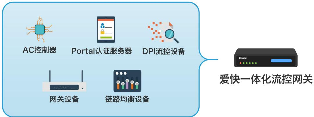
爱快在高性能硬件平台上集成了包括 DPI 流控、负载均衡、网关、AC、认证服务器等功能，将传统组网模式整合并做简化，等同于将多台设备以及统一网管平台整合到一台设备，大幅降低了企业组网和维护成本；同时，传统组网中很多设备都采用串联组网方式，爱快融合网关很大程度上避免了单点性能瓶颈而降低整网性能。
