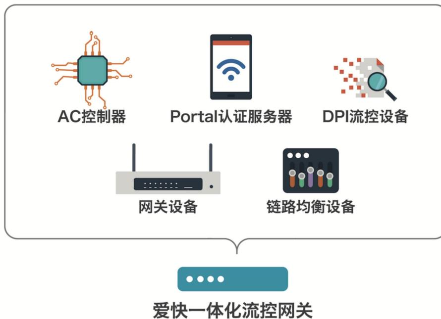
爱快在高性能硬件平台上集成了包括 DPI 流控、负载均衡、网关、AC、认证服务器等功能，将传统组网模式整合并做简化，等同于将多台设备以及统一网管平台整合到一台设备，大幅降低了企业组网和维护成本；同时，传统组网中很多设备都采用串联组网方式，爱快融合网关很大程度上避免了单点性能瓶颈而降低整网性能。
