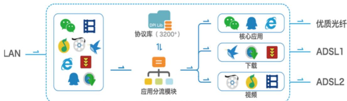
全新一代基于 DPI 的流量识别机制，全面提升 7 层应用协议识别速度和准确性，实现从终端到流量的可视化管理，数据全面直观呈现，更加精细化的流量管控配合多线接入、多拨技术、链路均衡和应用分流等功能结合，加之不间断更新的 3200 款以上 DPI 特征库，将核心应用分流至优质光纤，将下载、视频等应用分流至低价的 ADSL 宽带，降低 80% 以上的带宽成本。
