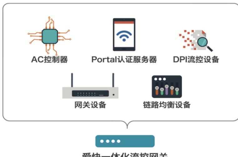
爱快在高性能硬件平台上集成了包括 DPI 流控、负载均衡、网关、AC、认证服务器等功能，将传统组网模式整合并做简化，等同于将多台设备以及统一网管平台整合到一台设备，大幅降低了用户组网和维护成本；同时，传统组网中很多设备都采用串联组网方式，爱快融合网关很大程度上避免了单点性能瓶颈而降低整网性能。
