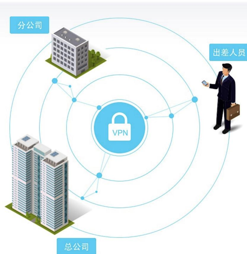
支持 IPsec、PPTP、L2TP 及 Open VPN 服务器与客户端功能，让企业的不同区域的部门随时访问公司局域网的 ERP、CRM、内部服务器等生产系统，提高工作效率。外出员工可以随时随地通过私有的通道安全的访问到公司内部网络获取相应资源，同时支持点对网和网对网 VPN 安全互联。
