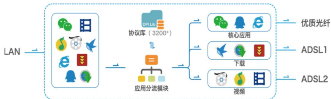
全新一代基于 DPI 的流量识别机制，全面提升 7 层应用协议识别速度和准确性，实现从终端到流量的可视化管理，数据全面直观呈现，更加精细化的流量管控配合多线接入、多
