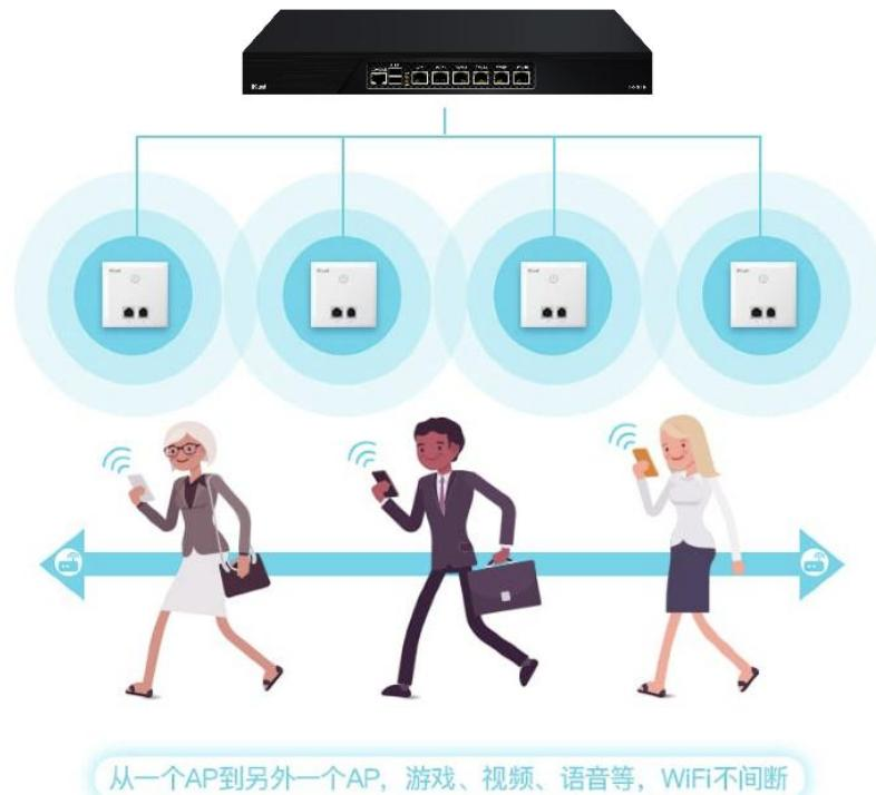
网关内置 AC 控制器，支持爱快 AP 集中管理，AP 可视为虚拟天线无需任何配置步骤，接入网络后自动读取无线配置，零基础组网、随时扩容；支持标准的无线漫游机制，实现
