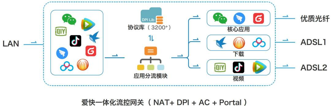
全新一代基于 DPI 的流量识别机制，全面提升 7 层应用协议识别速度和准确性，实现从终端到流量的可视化管理，数据全面直观呈现，更加精细化的流量管控配合多线接入、多拨技术、链路均衡和应用分流等功能结合，加之持续更新的 3200 款以上 DPI 特征库，为流量控制、调度、管理打下良好基础。
