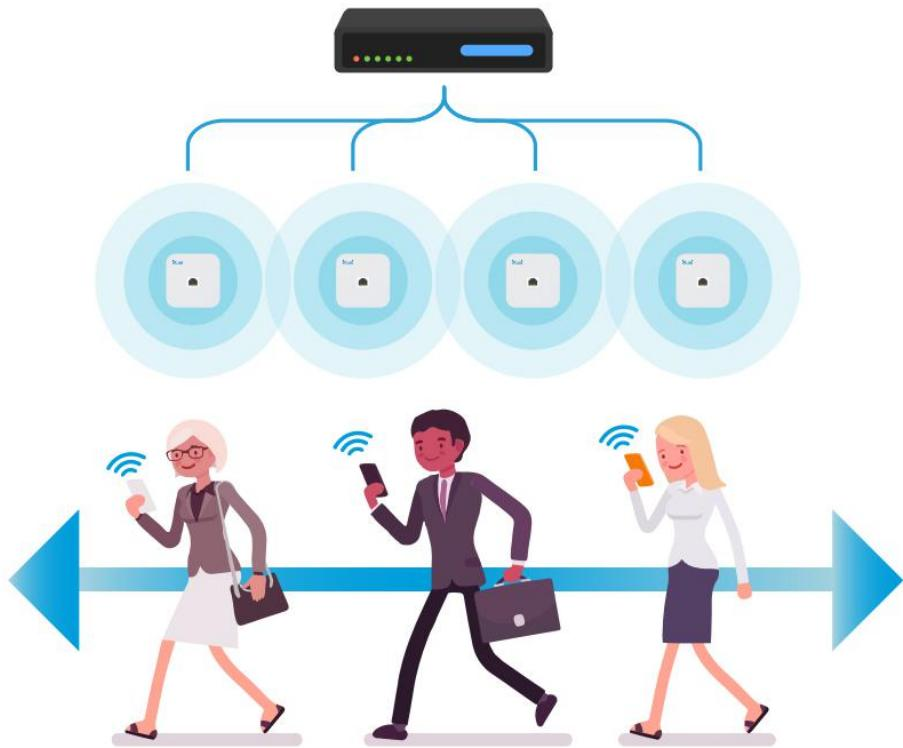
网关内置 AC 控制器，支持爱快 AP 集中管理，AP 可视为虚拟天线无需任何配置步骤，接入网络后自动读取无线配置，零基础组网、随时扩容；支持标准的无线快速漫游协议，实现 AP 之间无缝漫游，游戏、视频、语音等业务移动不间断。
