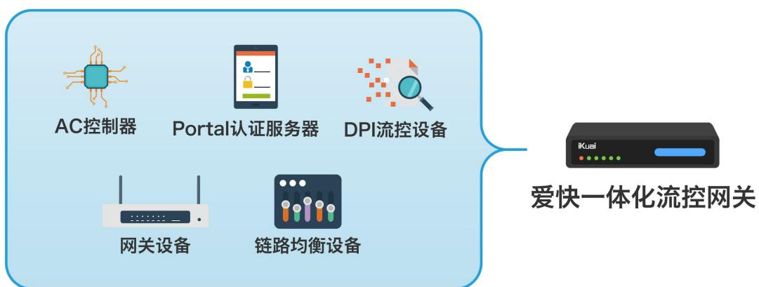
爱快在高性能硬件平台上集成了包括 DPI 流控、负载均衡、网关、AC、认证服务器等功能, 将传统组网模式整合并做简化, 等同于将多台设备以及统一网管平台整合到一台设备, 大幅降低了企业组网和维护成本; 同时, 传统组网中很多设备都采用串联组网方式, 爱快融合网关很大程度上避免了单点性能瓶颈而降低整网性能。
