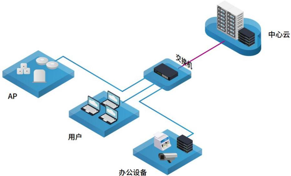
支持内网交换机（暂支持爱快 7000 系列）自动发现拓扑图，同时也支持第三方平台交换机手动发现，全网的交换机统一监控和管理，在网络拓扑上能直观的看到每个设备的链路关联状态和设备在线状态，支持直接在拓扑图上点击设备查看设备详情，大幅度提升了 IT 运维的效率；另外交换机工作异常后，支持告警信息实时推送，第一时间推送到微信和邮箱，同时也支持企业微信和钉钉机器人推送告警信息，IT 部门可以及时了解出问题的设备和端口，极大的节省网络管理成本和运维效率。
