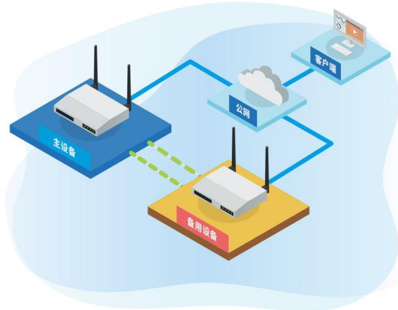
双机热备主要是实时数据、报警信息和变量历史记录的热备。主机从设备采集数据，并产生报警和事件信息。从机通过网络从主机获取实时数据和报警信息，而不会从设备读取或自己产生报警信息，主从机都各自记录变量历史数据。同时，从机通过网络监听主机，从机与主机之间的监听采取请求与应答的方式，从机以一定的时间间隔（冗余机心跳检测时间）向主机发出请求，主机应答表示工作正常，主机如果没有作出应答，从机将切断与主机的网络数据传输，转入活动状态，改由下位设备获取数据，并产生报警和事件信息。此后，从机还会定时监听主机状态，一旦主机恢复，就切换到热备状态，通过这种方式实现了热备。
