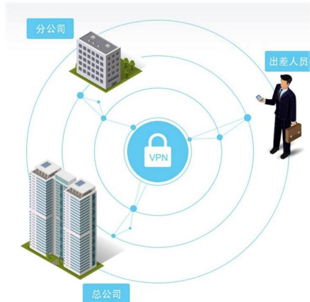
支持 IPsec、PPTP、L2TP 及 Open VPN 服务器与客户端功能，支持远程随时访问局域网 NAS、内部服务器等设备，节省网络组建成本，同时支持点对网和网对网 VPN 安全互连。
